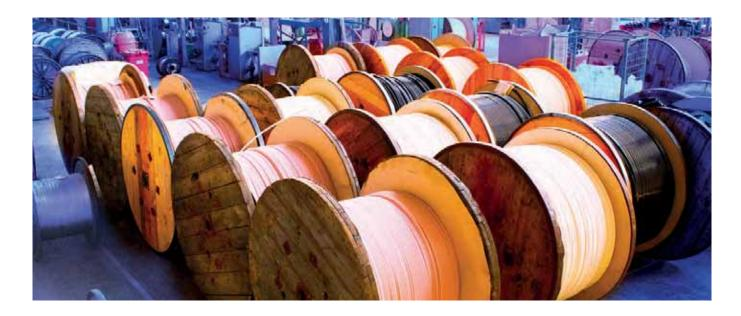
RG-Kabel wurden ursprünglich für den militärischen Einsatz konzipiert und standardisiert. Ihre elektrischen und mechanischen Eigenschaften wurden an die im Laufe der Zeit veränderten technischen Anforderungen angepasst. RG-Kabel sind heute international als Standard etabliert und werden in allen Bereichen der Elektronik, vor allem in der Mess- und Funktechnik und der Informationstechnik eingesetzt. Eine Vielzahl ebenfalls genormter Steckverbinder stehen zur Verfügung.
