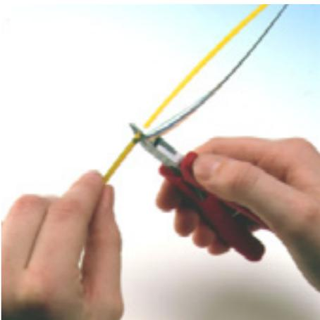
16. ... Faser bzw. Faserbündel herausheben und untere offene Bündelader mit Seitenschneider auf beiden Seiten abschneiden. Fasern reinigen.
