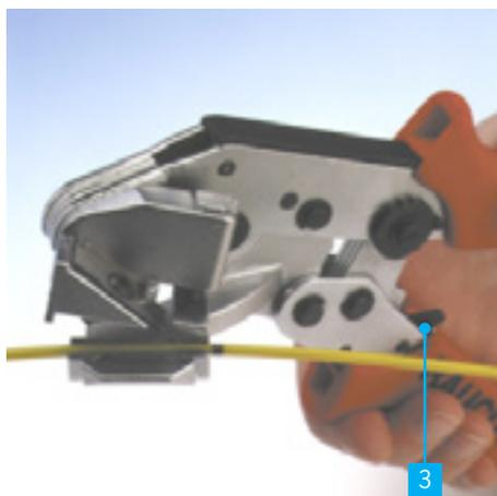
4. Bündelader reinigen, Anschneidebereich auf Bündelader markieren
