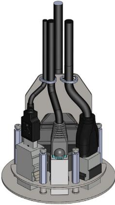
1. Die vier Schrauben für Klemmring lockern und Klemmring aus Schlüssellochführungen und Schlitzen abnehmen.
