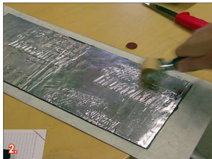
1. Testaus suoritettiin kiinnittämällä matot ja massat peltilevyyn. Levyn reunoille on jätetty tilaa testikoteloon kiinnitystä varten.
