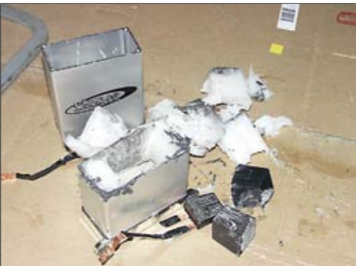
Focusin sisältä löytyi paljon tyhjää tilaa. Reilu puolet tilavuudesta on jotain muovimössöä ja sisältä löytyy pieni muutaman hiilikalvokondensaattorin sisältävä muovirasia! No tämä näkyi kyllä myös mittauksissa. Huijausta!
